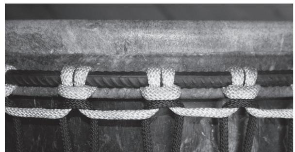
▲ Foto 14: Klemmspannung (8mm Baustahl). © R. Polak, 2011
